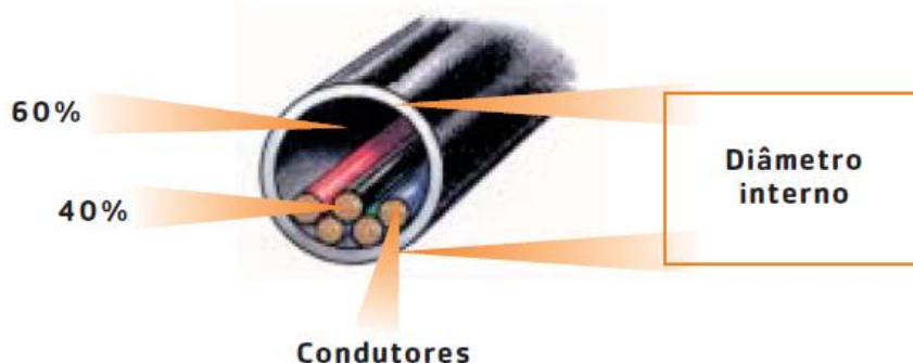
Figura 64 - Eletroduto com condutores embutidos
