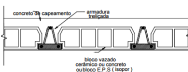
vigota com armadura trelaçada
